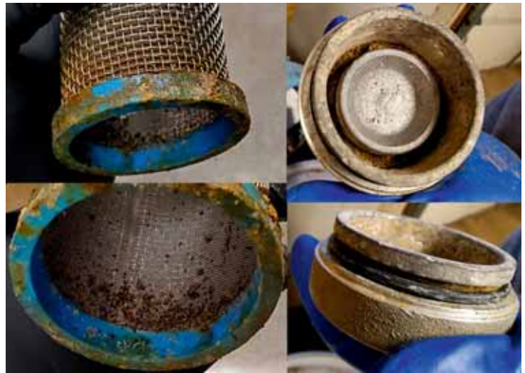
Ще одне дуже «брудне» місце обприскувача – фільтри. Невдала бакова суміш може повністю заповнити комірки фільтра липким, важкорозчинним у воді осадом
