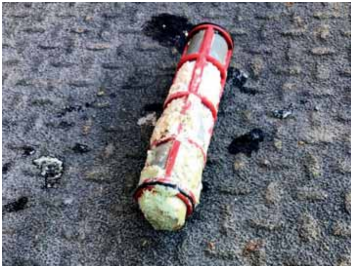
Ще одне дуже «брудне» місце обприскувача – фільтри. Невдала бакова суміш може повністю заповнити комірки фільтра липким, важкорозчинним у воді осадом
